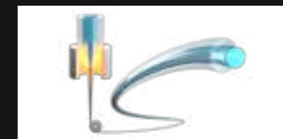
Faserzug nach der Molten-Core-Methode © Leibniz-IPHT
