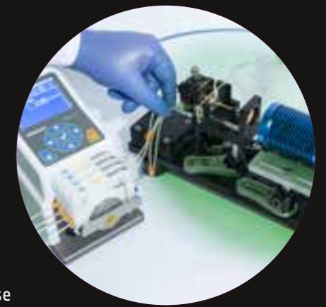
LSPR-Gerät (Localized Surface Plasmon Resonance) zum Messen der Bindungskinetik von Antibiotikaresistenzgenen. Mit photonischen Verfahren werden kleinste genetische Veränderungen identifiziert. © Sven Döring
