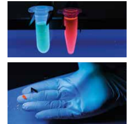
Abhängig von Größe und Oberflächenbehandlung leuchten die Partikel in Suspension grün-blau oder rot. Auch im festen Zustand zeigt Silicium rote Photolumineszenz.
