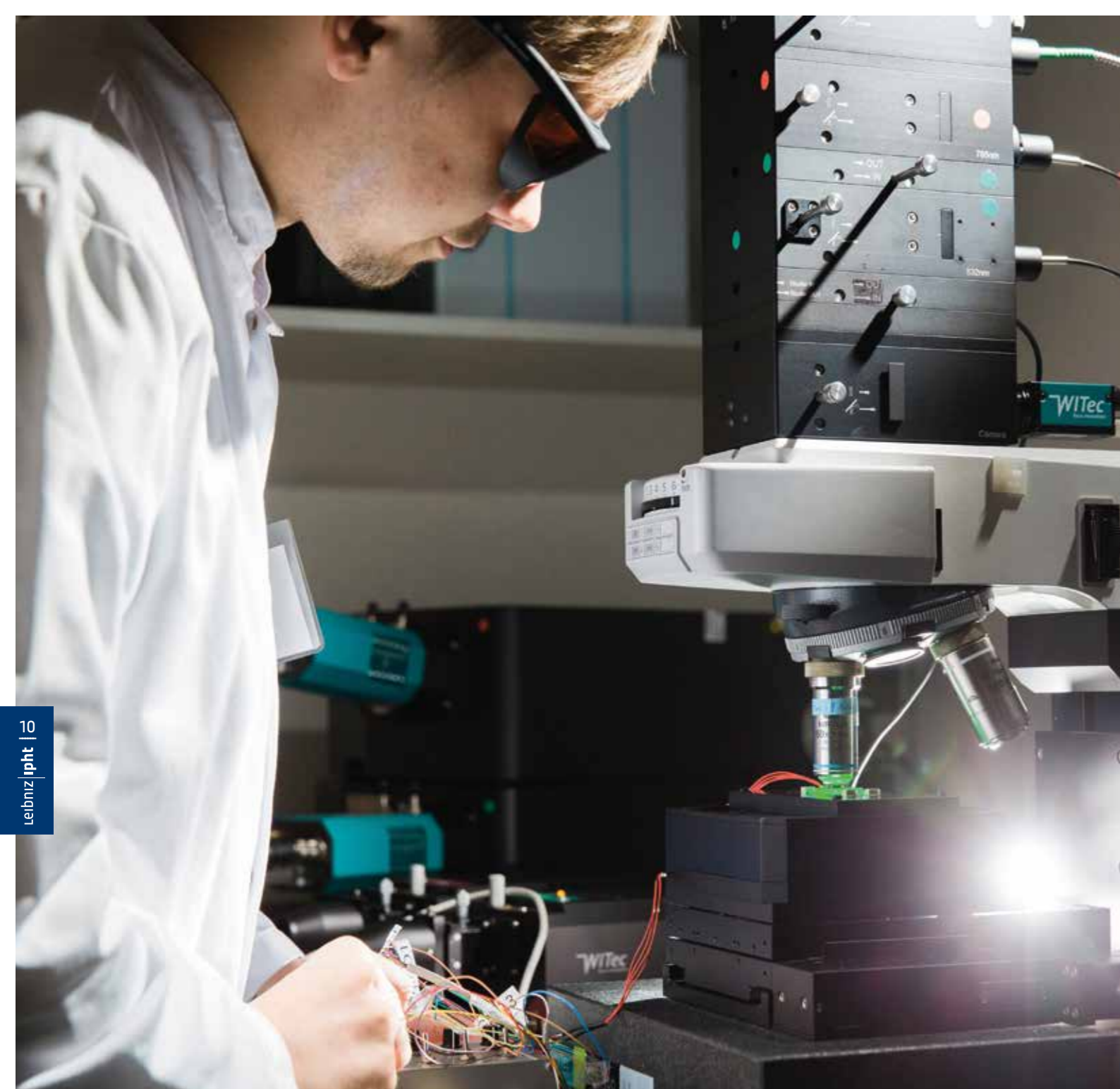
Mit einem Raman-Mikrospektroskop erfasst Doktorand Marcel Dahms die spezifischen Schwingungsspektren der im Chip fixierten Bakterien.
